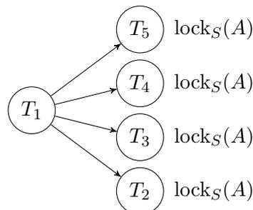
In dieser Darstellung haben  $T_2$  bis  $T_5$  bereits S-Sperren auf  $A$ . Die Transaktion  $T_1$  will eine X-Sperre und fügt dem Wartegraphen so vier Kanten hinzu.
